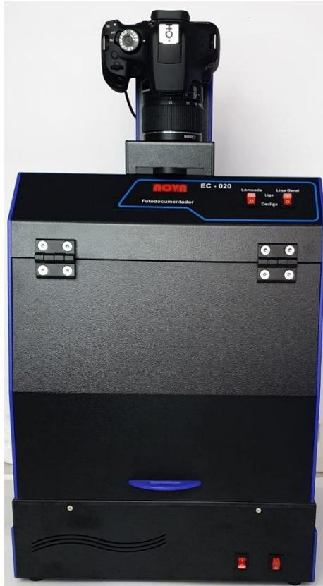
O sistema digital para aquisição de imagens de géis de agarose.
